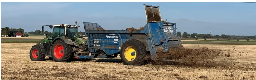
Figur 12. Fastgödselspridare lägger gödseln ovanpå marken. (Foto: Gunilla Frostgård)
