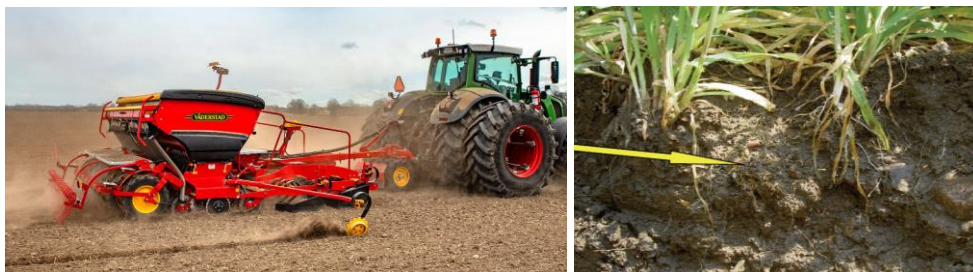
Figur 10 och 11. Med en så kallad kombisåmaskin placeras gödseln under marken på lämpligt avstånd från utsädet. Resultatet blir att rötterna samlas som en "rotboll" runt gödselkornet, vilket gör att grödan tidigt kommer åt näringen och att effektiviteten ökar. Foto: Väderstad respektive Lena Holm, Jordvetaren.
